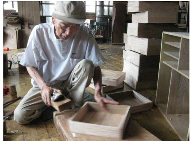
抽斗を鉋で削りながら本体に仕込みます 引き出し内は会津産の最高級桐材です。
